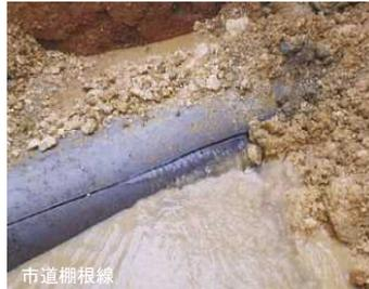
塩ビ管の破損状況(疲労破壊)
