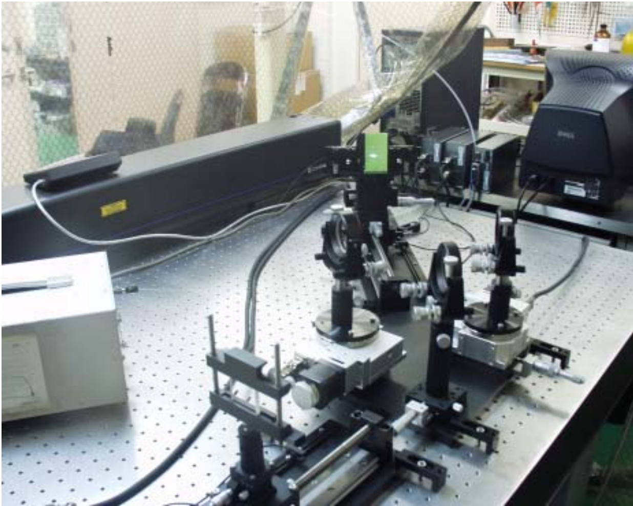
写真 4.1 F B G 作製システムの概観
