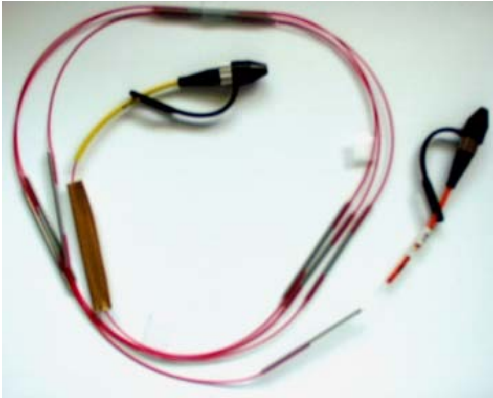
写真 5.1 PMD エミュレータの試作器
